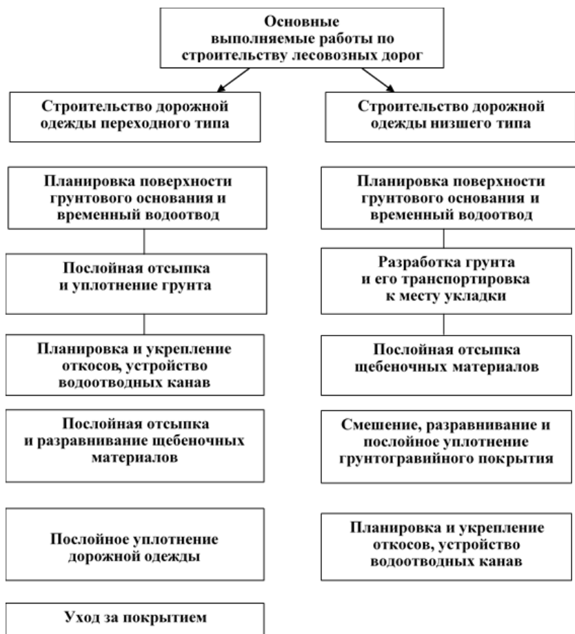
Рис. 5.9. Последовательность работ при строительстве лесовозных дорог
