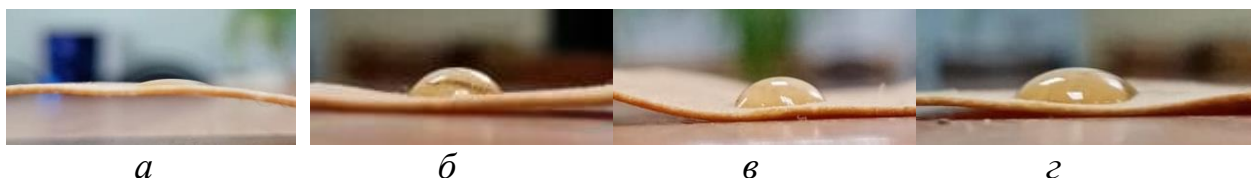
Рис. 2. Краевые углы смачивания для контрольного образца ( а ) и образцов, подверженных ацетилированию в уксусной кислоте в течении 24 ( б ), 48 ( в ) и 72 ( г ) часов
