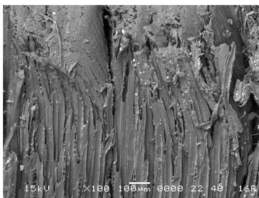
Рис. 7. Макрофотография торцевого среза технологической щепы ( $\rho = 117$  мкм)
