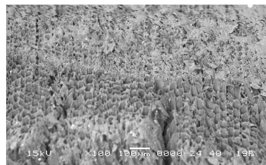
Рис. 4. Макрофотография торцевого среза технологической щепы ( $\rho = 65$  мкм)
