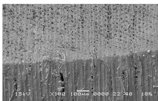
Рис. 6. Макрофотография торцевого среза технологической щепы ( $\rho = 94$  мкм)
