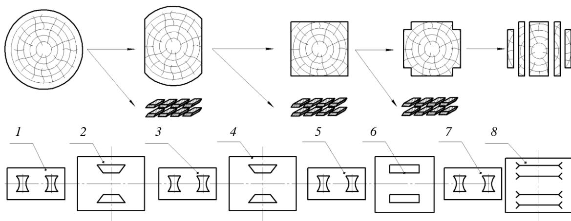
Рис. 1. Технологическая схема получения щепы на фрезерно-брюсющей линии LINK V25:
