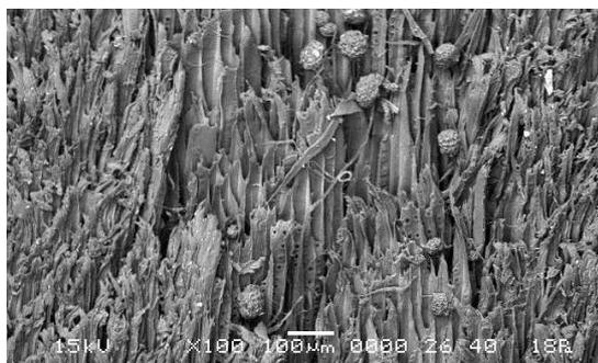
Рис. 5. Макрофотография торцевого среза технологической щепы ( $\rho = 81$  мкм)
