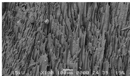
Рис. 3. Макрофотография торцевого среза технологической щепы ( $\rho = 38$  мкм)
