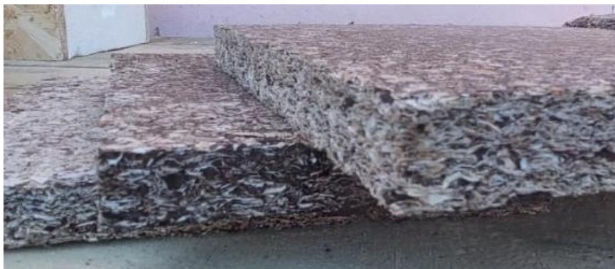
Рис. 1. Лабораторные образцы древесно-торфяных плит
