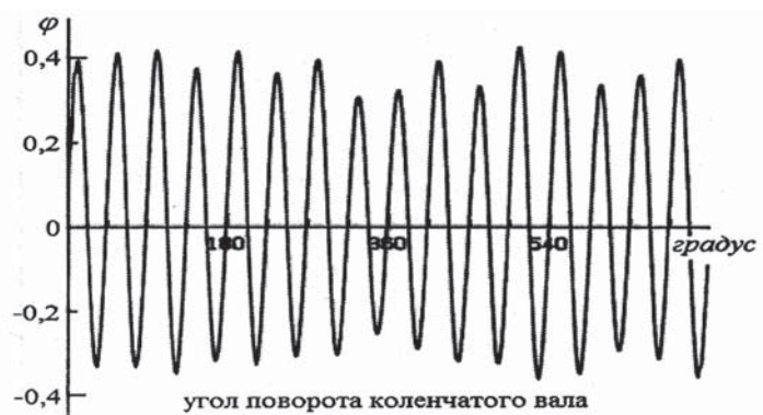
Рис. 5. Одноцикловая временная диаграмма угла закрутки носка коленчатого вала при n = 1900 \text{ мин}^{-1} без демпфера крутильных колебаний
