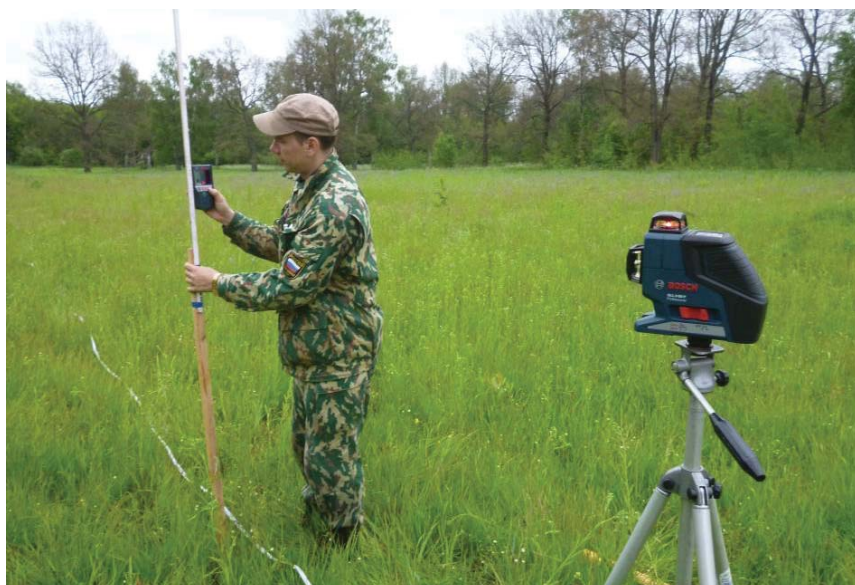
Рис. 1. Момент проведения замера. У исследователя в руках мерная линейка и приемник сигнала от лазерного нивелира
