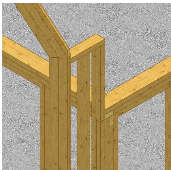
Рис. 2. Соединение различных элементов каркаса дома
