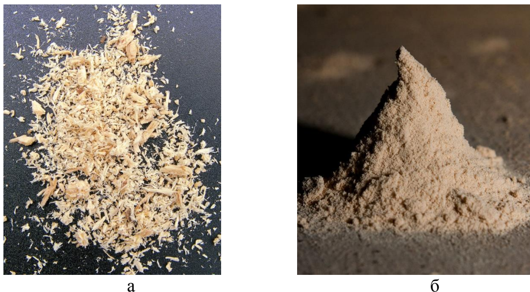
Рис. 1. Древесная щепа (а) и древесная мука (б), используемые в производстве древесно-полимерных композитов
