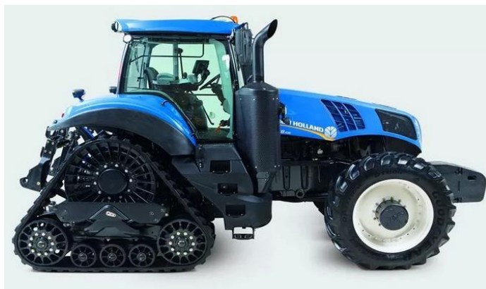
Рис. 1. Пример полугусеничного хода трактора New Holland t8.435
