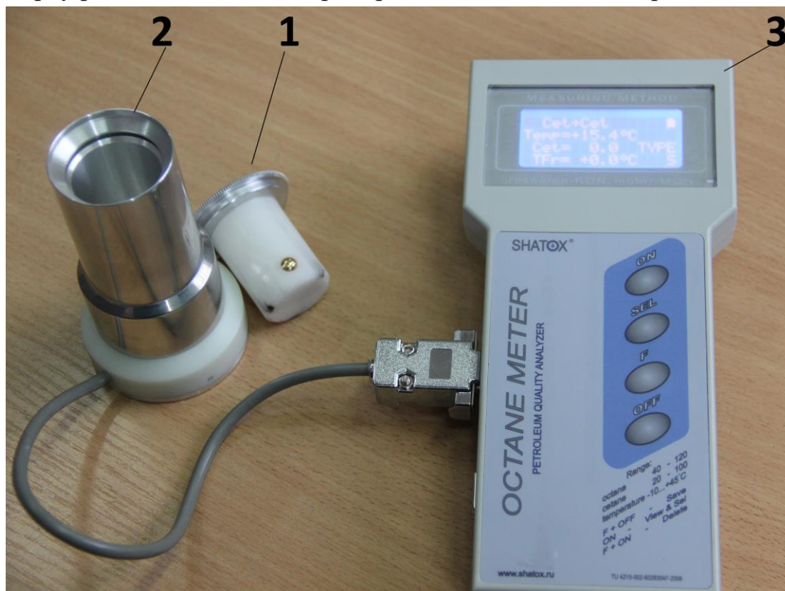
Рис. 9. Октанометр Snatox SX-100K: 1 – имитатор; 2 – датчик с кабелем связи; электронный вычислительный блок.
