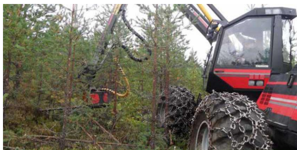
Рис. 8. Машинизированная прочистка хвойного молодняка харвестером
