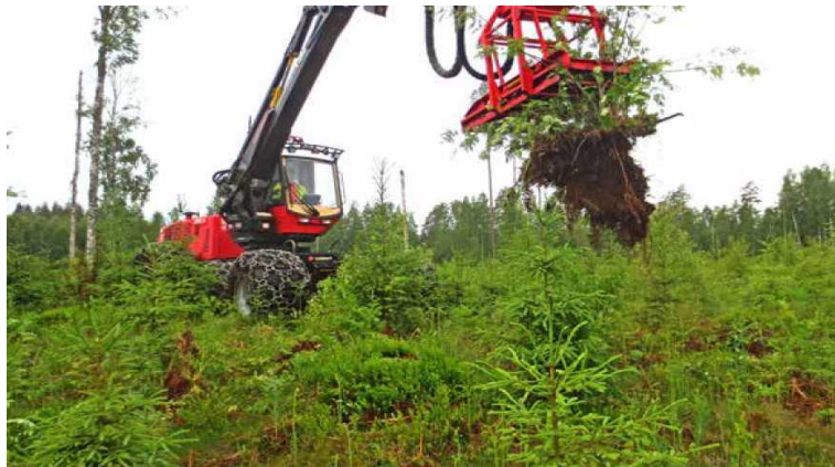
Рис. 3. Машинизированное удаление нежелательной растительности – осветление
