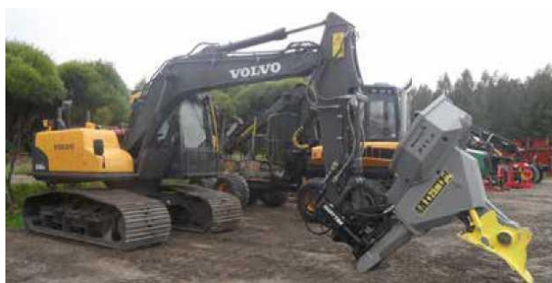
Рис. 10. Экскаватор, оснащенный лесопосадочным устройством
