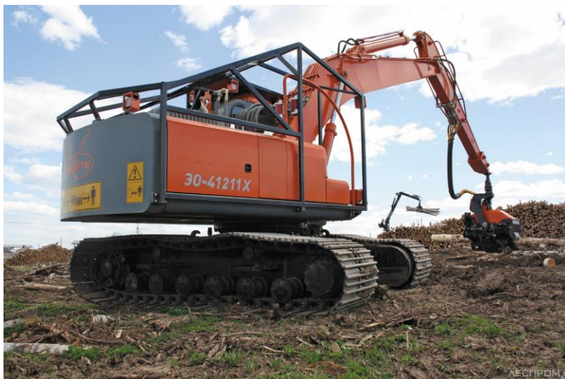
Рис. 1. Экскаватор ЭО-41211Х со съемным харвестерным агрегатом для выполнения лесохозяйственных работ
