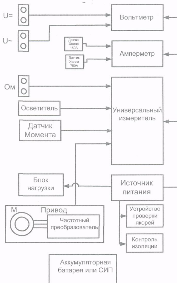
Рис. 5. Схема электрическая функциональная стенда
