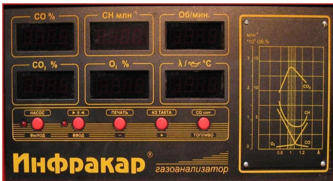
Рис. 4. Лицевая панель газоанализатора «Инфракар»
