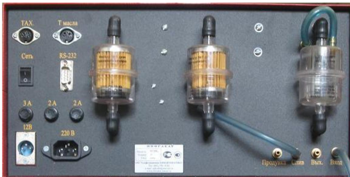
Рис. 5. Задняя панель газоанализатора «Инфраклар»
