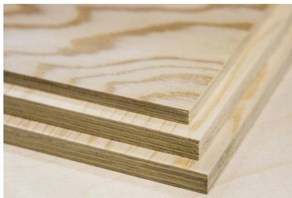
Внешний вид фанерной плиты с использованием клея на основе СФЖ-3014
