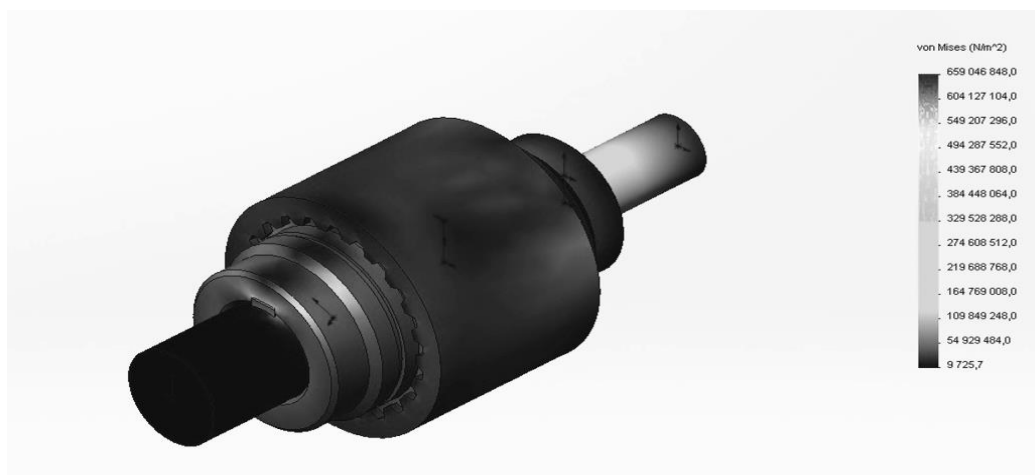
Рис. 4. Поля распределения напряжений в материале муфты
