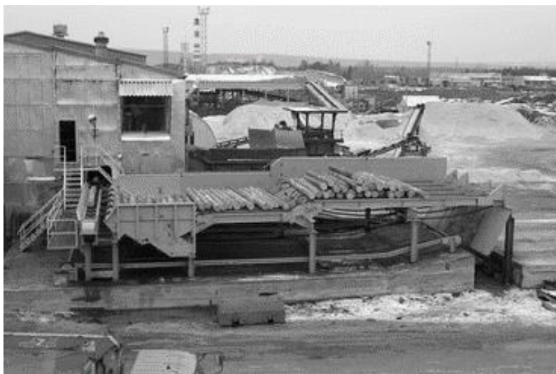
Рис. 1. Фотография устройства поштучной выдачи пиловочника
