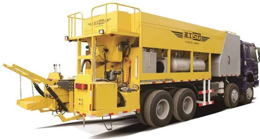
Рис. 3. Внешний вид машины «Сларри-сил»
