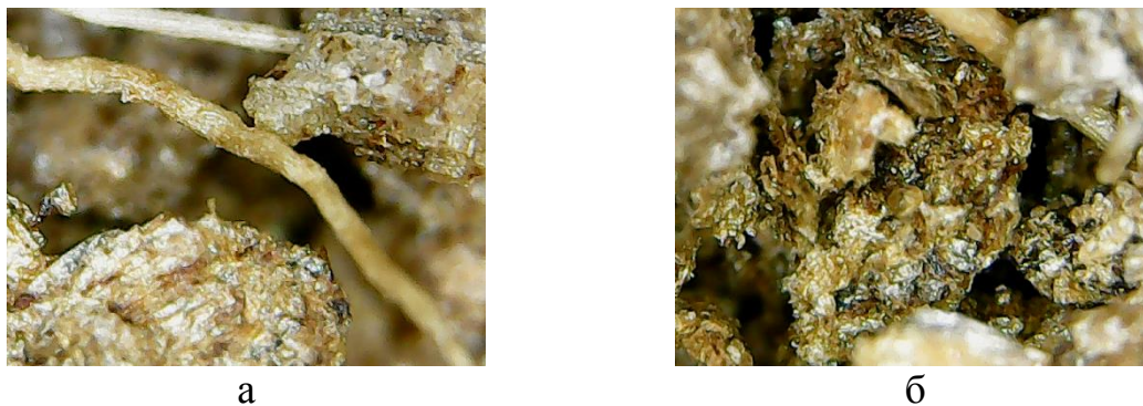
Рис. 1. Микрофотография (x40) исследуемого пресс-сырья: a – исходный кокосовый субстрат; б – измельченный кокосовый субстрат
