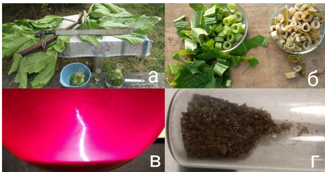
Рис. 1. Процесс выделения фуранокумаринов: а – сбор сырья; б – листья до и после экстрагирования; в – осадок фуранокумаринов, выпавший при подкислении экстракта; г – образец полученной суммы фуранокумаринов
