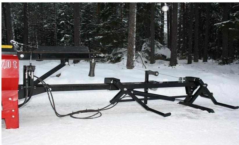
Рис. 2.31. Подъемник для подачи дровяного долготья в процессор JAPA 495
