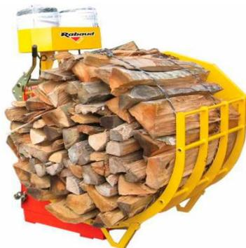
Рис. 2.49. Установка для упаковки короткомерных колотых дров на платформе сплиттера бревен RABAUD
