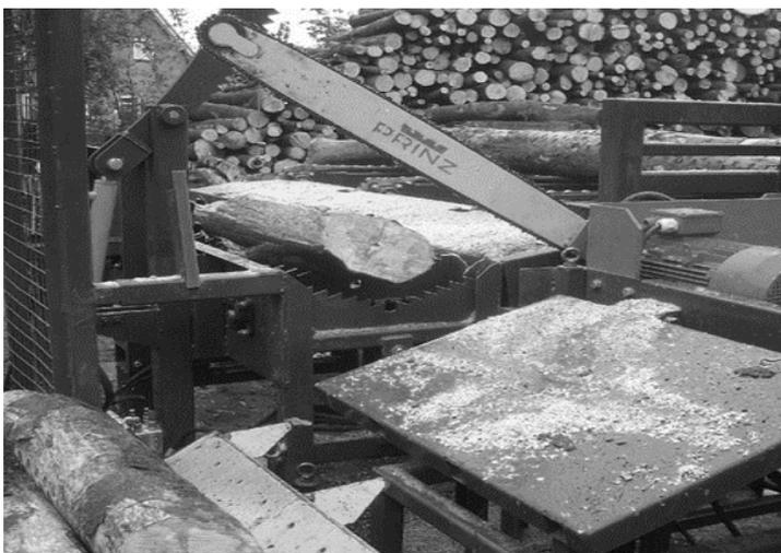
Рис. 2.4. Общий вид станка для разделки долготя на короткомерные отрезки с цепной пилой LOGSTAR COMBI
