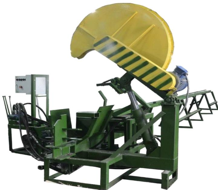
Рис. 2.29. Общий вид процессора ДРЛ-400
