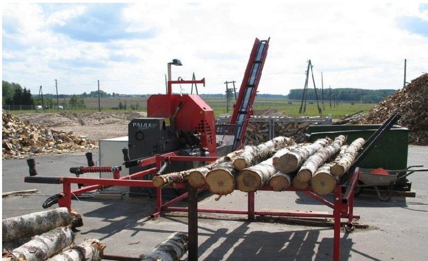
Рис. 2.33. Эстакада механическая для бревен Palax Log Deck
