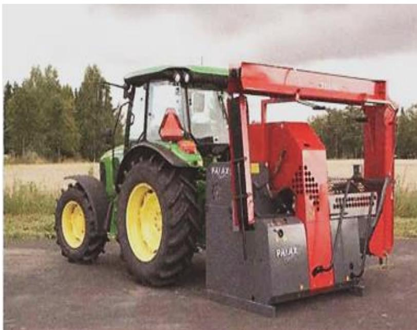
Рис. 2.16. Общий вид процессора в положении для транспортировки
