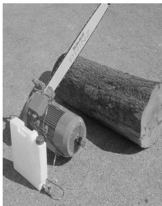
Рис. 2.3. Общий вид универсального пильного блока BASIC BLOCK
