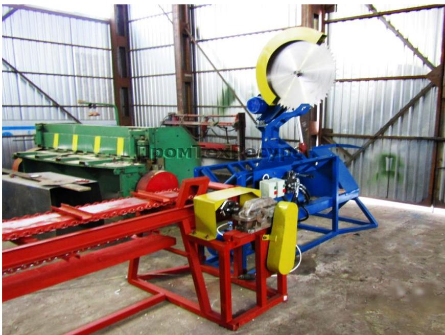
Рис. 2.1. Общие виды установки для разделки долготья на коротье
