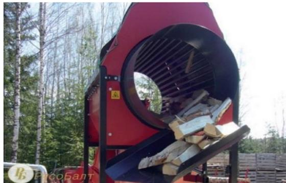
Рис. 2.41. Барабанные очистители дров: а – Palax Cleaner; б – Jara 475
