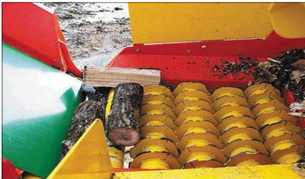
Рис. 2.42. Дисковый сепаратор
