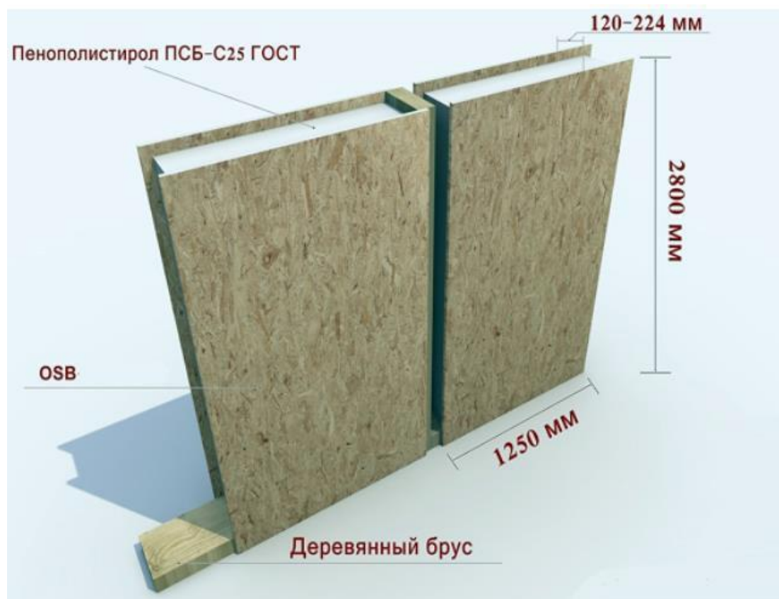
Рис. 1.15. Структура СИП-панели
