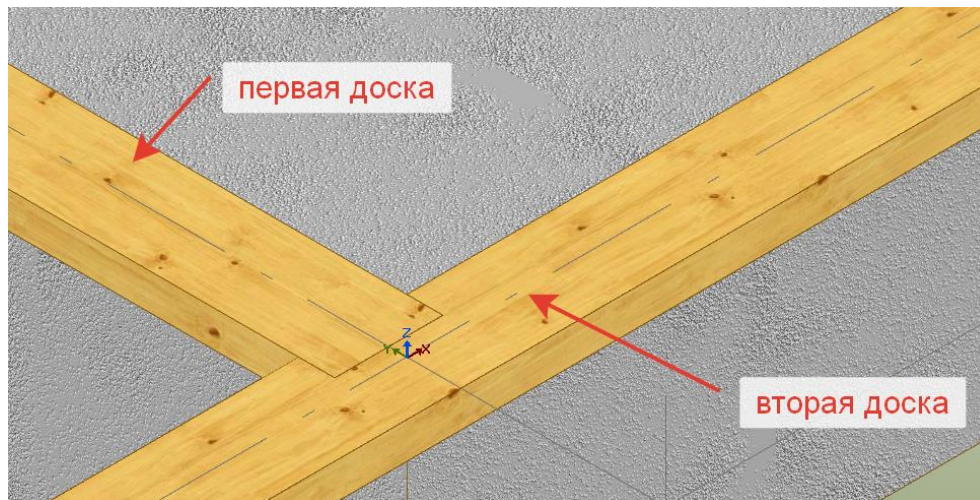
Рис. 2.19. Соединение досок обвязки
