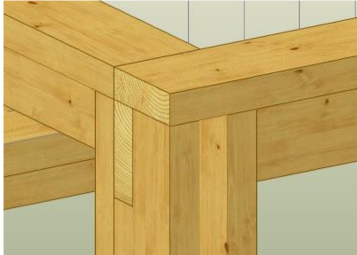
Рис. 2.41. Пример автоматического соединения стен
