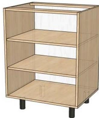
Рисунок 17.4 – Короб с двумя полками
