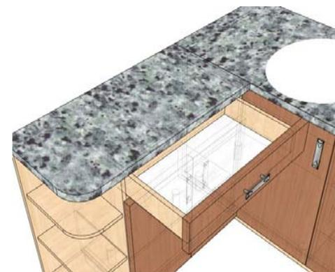
Рисунок 17.15 – Схема расположения выдвижного ящика и мойки
