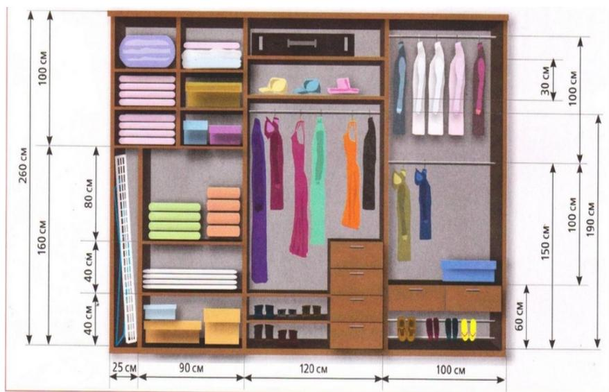
Рисунок 12.4 – Схема системы хранения одежды и белья
