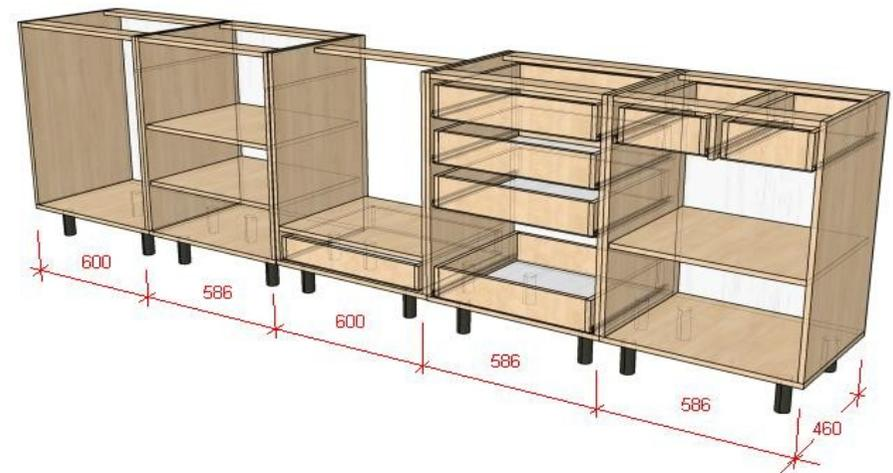
Рисунок 17.2 – Расчетная схема размеров нижних модулей
