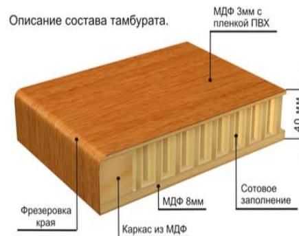
Рисунок 6.15 – Конструкция плиты с сотовым заполнением
