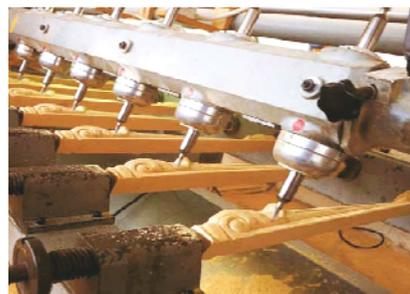
Рисунок 7.7 – Автоматизированное изготовление точеных элементов
