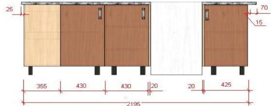
Рисунок 17.18 – Схема нижних корпусов
