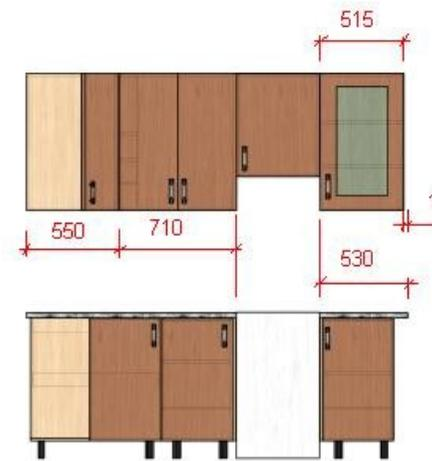
Рисунок 17.22 – Размеры модулей
