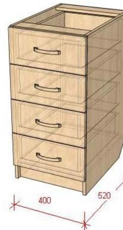
Рисунок 17.27 – Тумба с выдвижными ящиками
