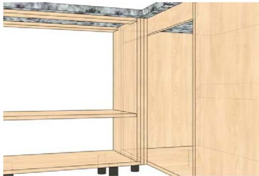
Рисунок 17.16 – Конструкция стыка углового короба и мойки
