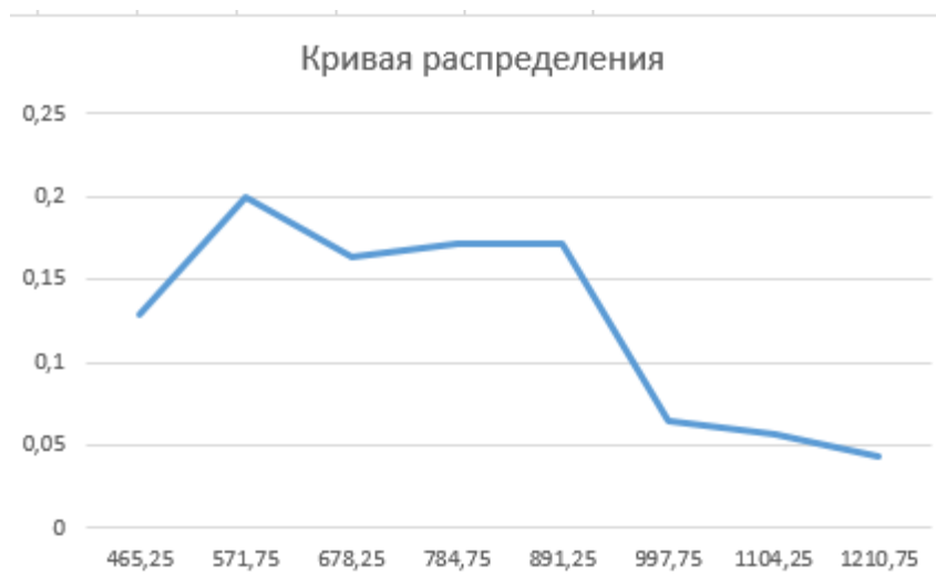
Рис. 18. Кривая распределения шероховатости поверхности пиломатериалов в опыте № 25
