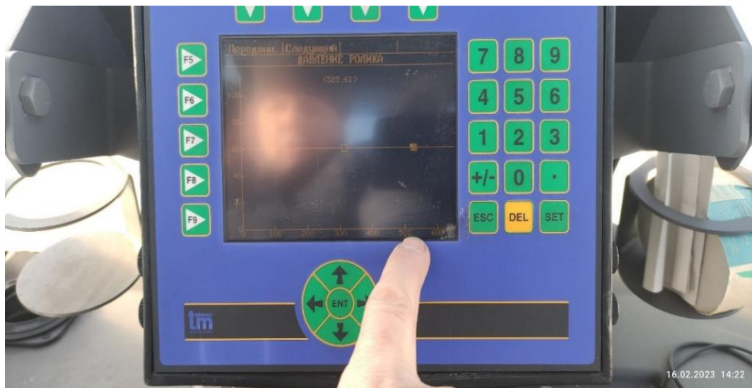
Рис. 2. Копия экрана настроек минимального давления протаскивающих валцов на измерительной системе Tech Measure 1000
