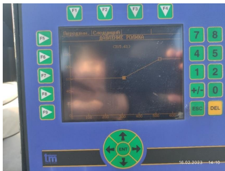
Рис. 1. Копия экрана заводских настроек давления по линейному закону протаскивающих валцов на измерительной системе Tech Measure 1000
