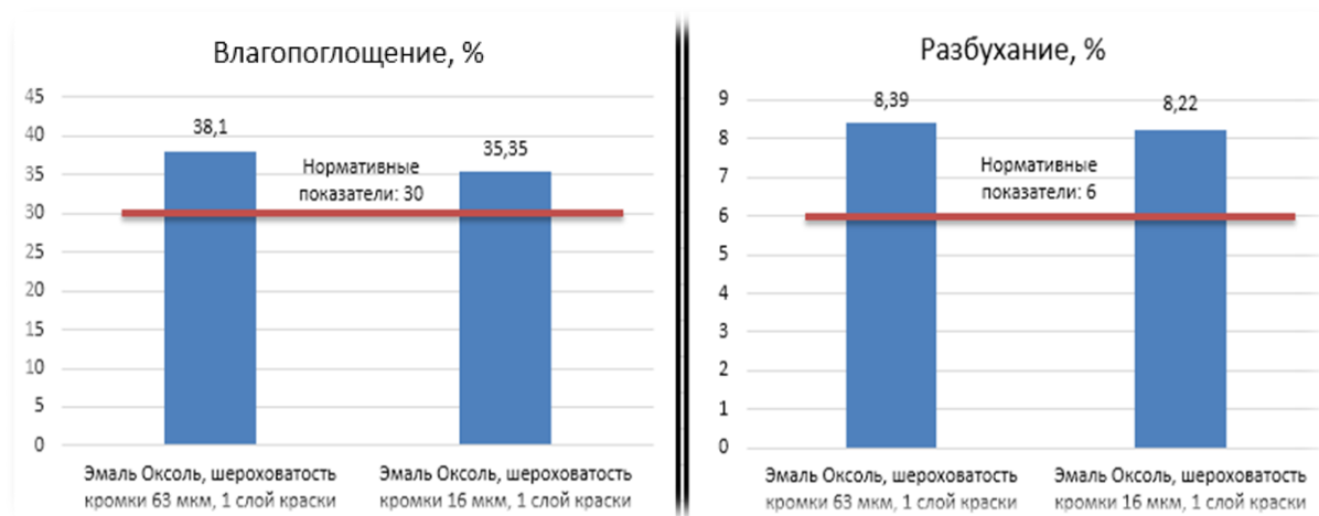
Рис. 1. Результаты исследований влияния шероховатости поверхности кромки фанеры на величину влагопоглощения и разбухания
