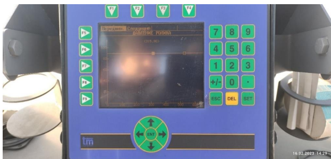
Рис. 3. Копия экрана настроек максимального давления протаскивающих вальцов на измерительной системе Tech Measure 1000
