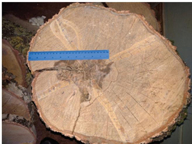
Рис. 4. Сердцевинная гниль и морозобойная трещина
