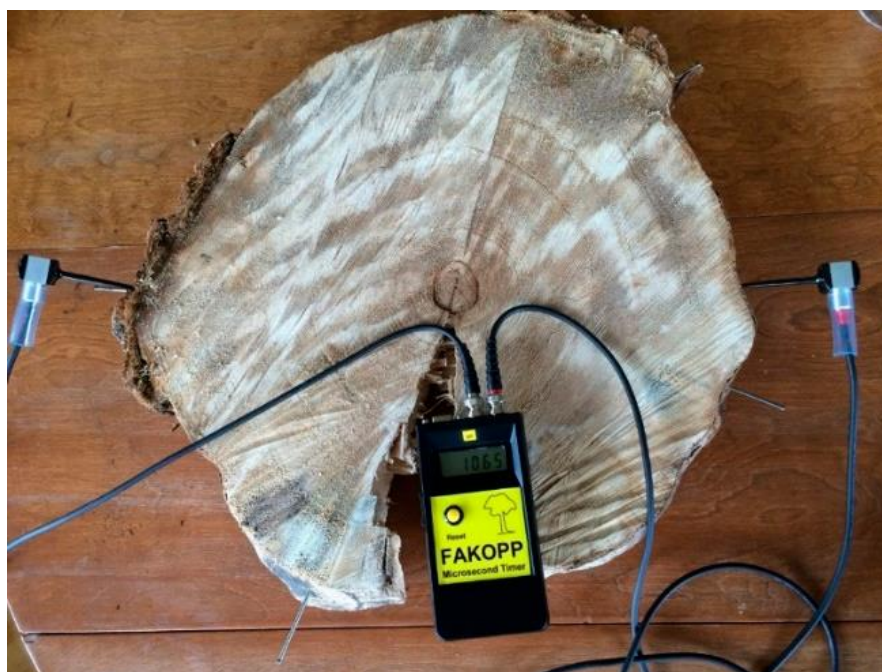
Рис. 10. Принцип применения микросекундного таймера Fakopp при тестировании диска ствола (Allison et al., 2020)
