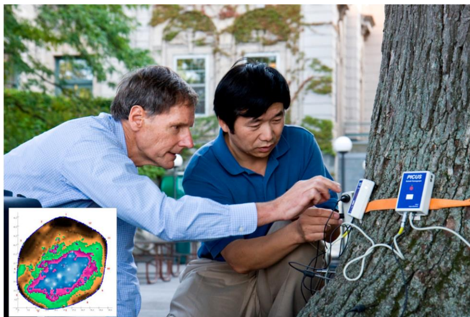
Рис. 15. Тестирующая мультисенсорная акустическая томография для регистрации распространения внутренних дефектов в стволе крупного дерева (Allison et al., 2020)
