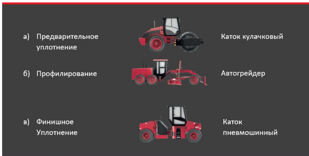
Рис. 2. Технология укрепления и уплотнения полученной смеси
