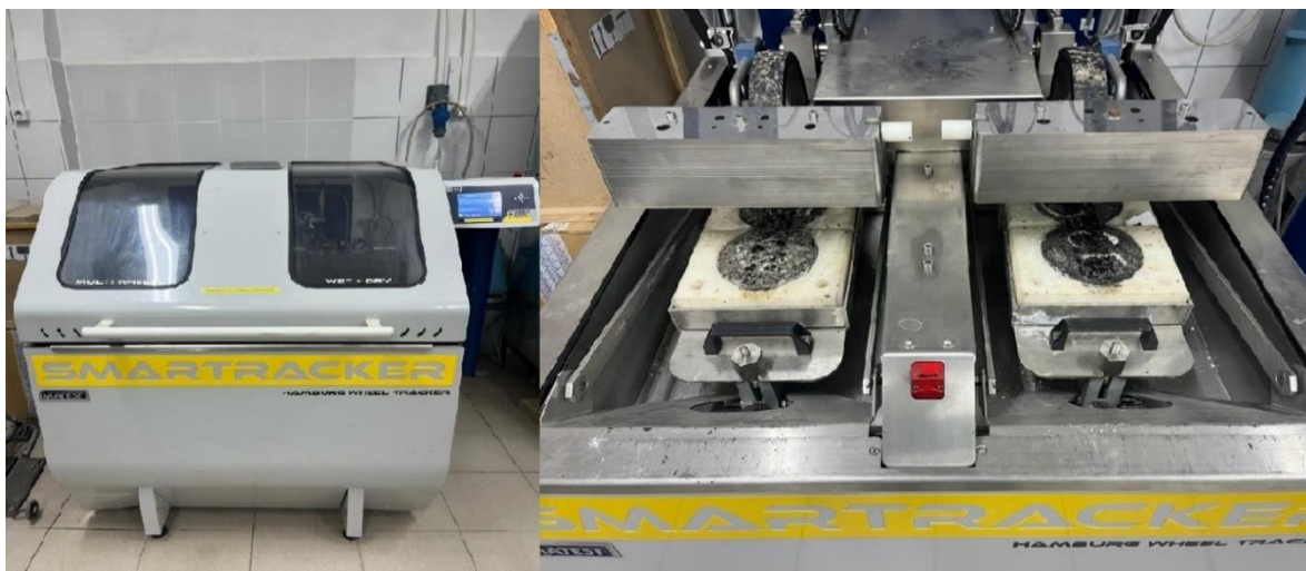
Рис. 4. Испытание асфальтобетона на колеобразование
