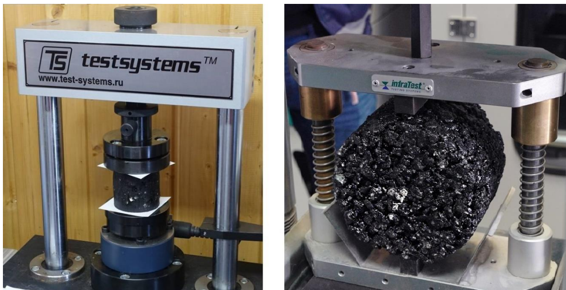
Рис. 3. Определение водостойкости асфальтобетонов
