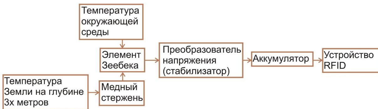
Рис. 2. Структурная схема электропитания устройства мониторинга лесного массива
