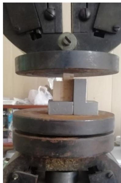
Рис. 4. Образец, закрепленный в специальном приспособлении, под нагрузкой испытательной машины
