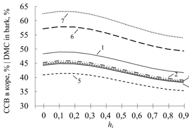
Рис. 2. Изменение ССВ в древесине вдоль по стволу дерева согласно модели (1)
