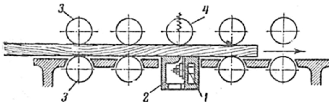
Рис. 3. Принципиальная схема работы циклевального станка:
