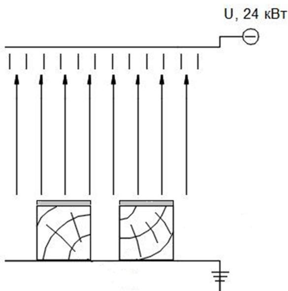
Рис. 6. Схема активации клеевой композиции воздействием аэроионизационной установки на стадии открытой выдержки
