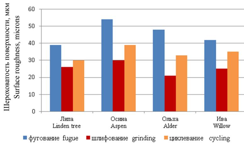
Рис. 5. Шероховатость поверхности образцов группы 2
