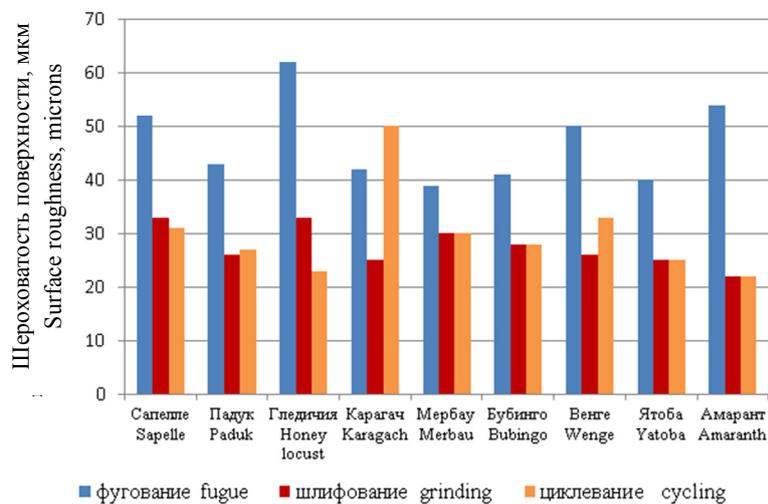
Рис. 7. Шероховатость поверхности образцов группы 4
