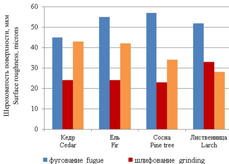
Рис. 4. Шероховатость поверхности образцов группы 1
