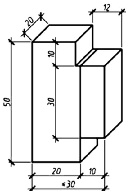
Рис. 3. Форма и размеры образца для испытаний на скалывание
