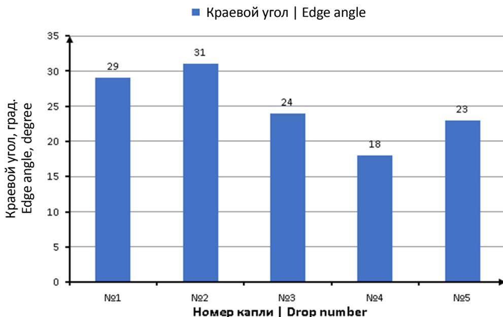
Рис. 5. Значения краевого угла смачивания эпоксидной смолы
