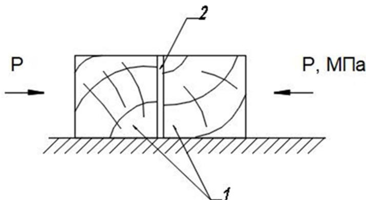
Рис. 2. Схема склеивания ламелей: 1 – буковые ламели; 2 – клеевой слой
