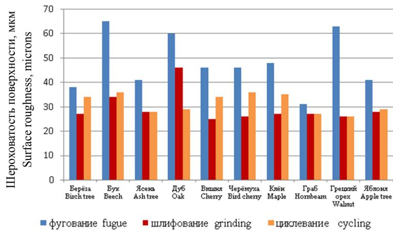
Рис. 6. Шероховатость поверхности образцов группы 3
