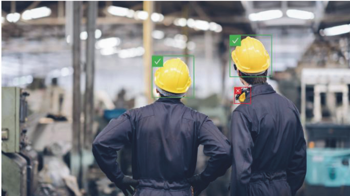
Рис. 7. Пример контроля применения средств индивидуальной защиты Fig. 7. Example of monitoring the use of personal protective equipment
