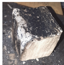
Рис. 9. Образец № 3 известково-глиняносолевая обмазка Fig. 9. Sample № 3 lime-clay-salt coating
