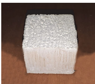
Рис. 2. Образец № 2 суперфосфат с водой 40/60 Fig. 2. Sample № 2 superphosphate with water 40/60
