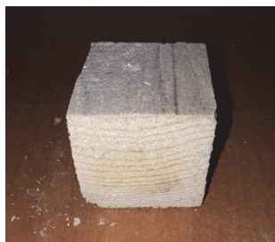
Рис. 5. Образец № 5 пропитка с жидким стеклом Fig. 5. Sample № 5 impregnation with liquid glass
