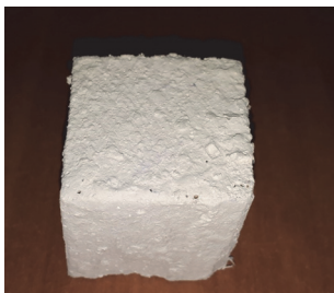
Рис. 1. Образец № 1 суперфосфат с водой 70/30 Fig.1. Sample № 1 superphosphate with water 70/30
