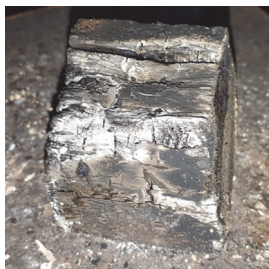
Рис. 10. Образец № 4 пропитка с борной кислотой и содой Fig. 10. Sample № 4 impregnation with boric acid and soda
