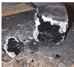
Рис. 11. Образец № 5 пропитка с жидким стеклом Fig. 11. Sample № 5 impregnation with liquid glass
