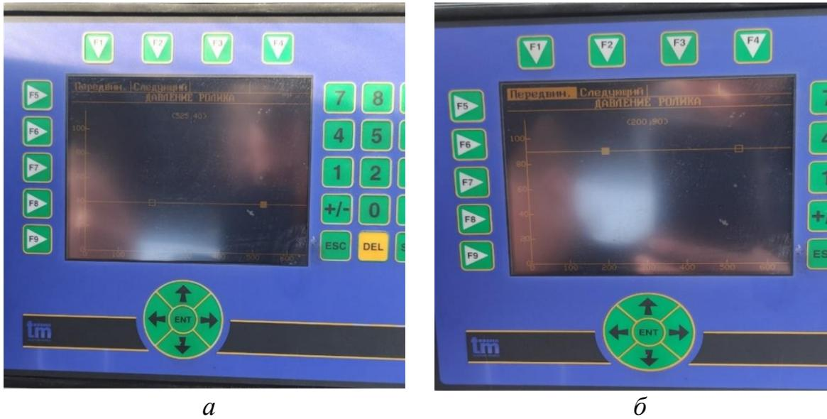
Рис. 3. Настройка давления протаскивающего механизма на измерительной системе ТМ 1000 : *а* – минимального; *б* – максимального
