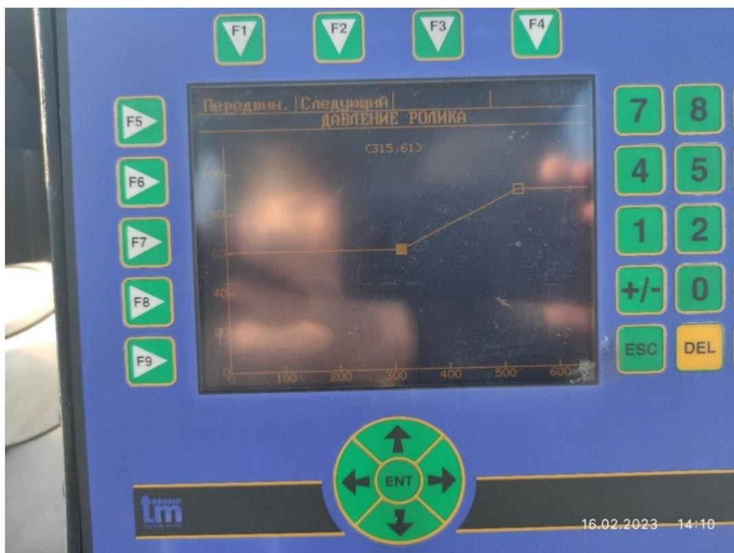
Рис. 2. Настройка давления по линейному закону механизма протаскивания на измерительной системе TM 1000
