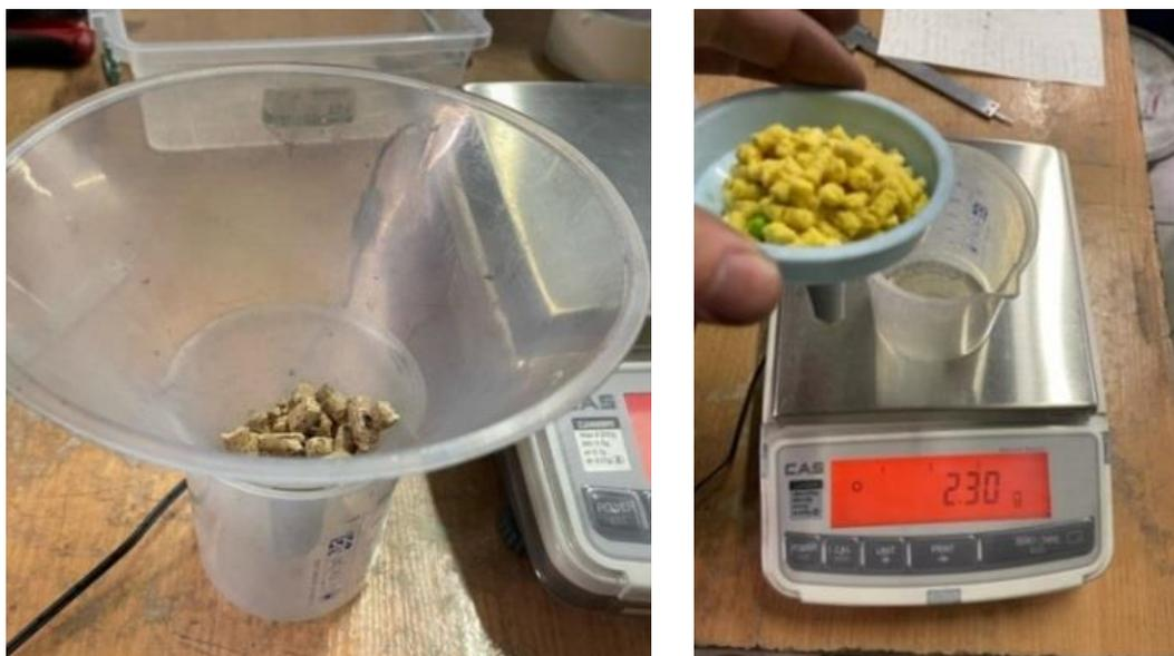
Рис. 3. Определение водопоглощения наполнителя
