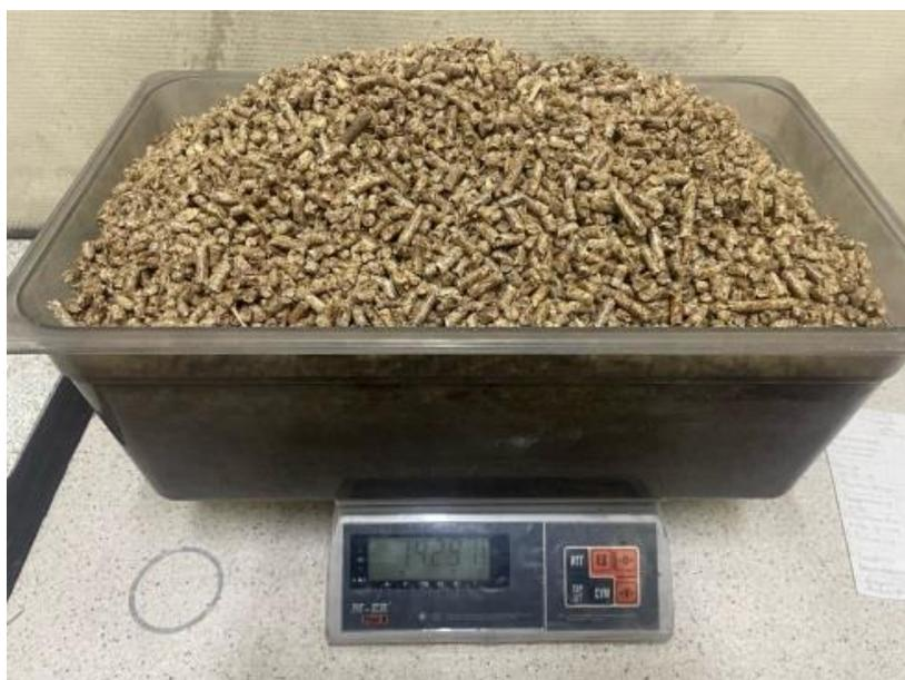
Рис. 1. Определение отклонения фактической массы от номинальной
