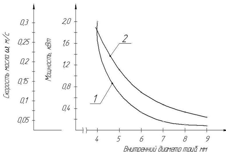
Зависимость скорости масла и потерь мощности на трение масла в трубопроводе подшипников сетководущих валов и СЦ схемы РГП относительно схемы КРР от диаметра труб:
