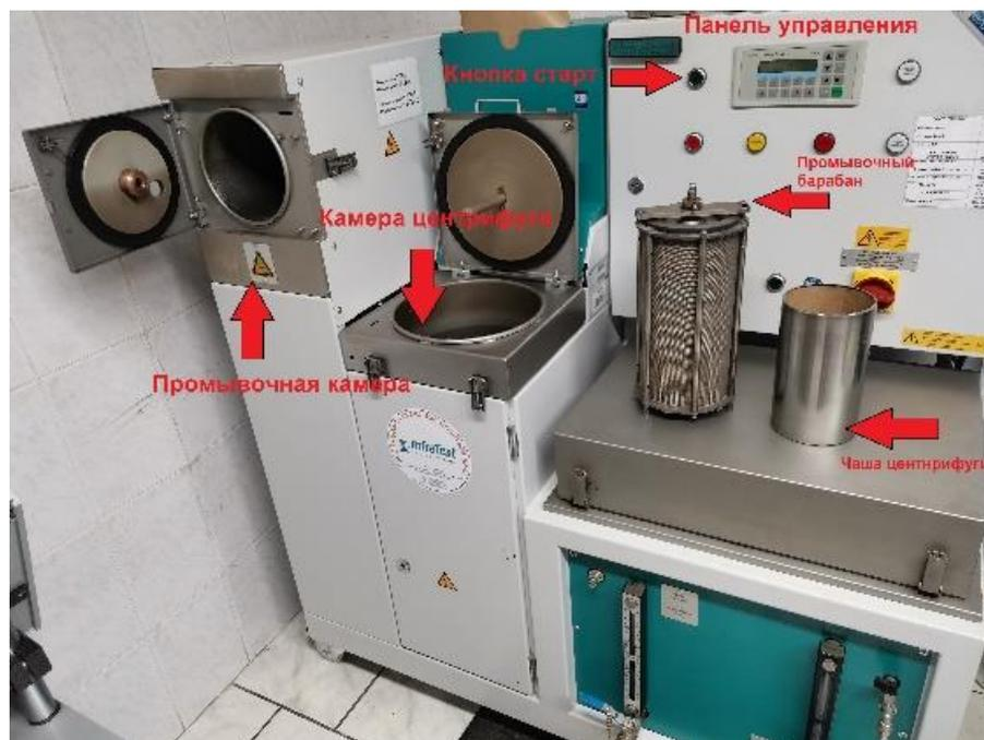
Рис. 2. Асфальтоанализатор
