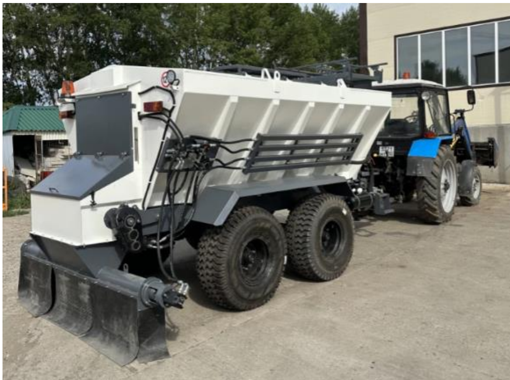
Рис. 2. Цементораспределитель МВЦ 8АГ от ООО «УралАгроМаш»
