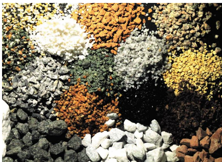
Рис. 5. Минеральные наполнители для бетонных смесей
