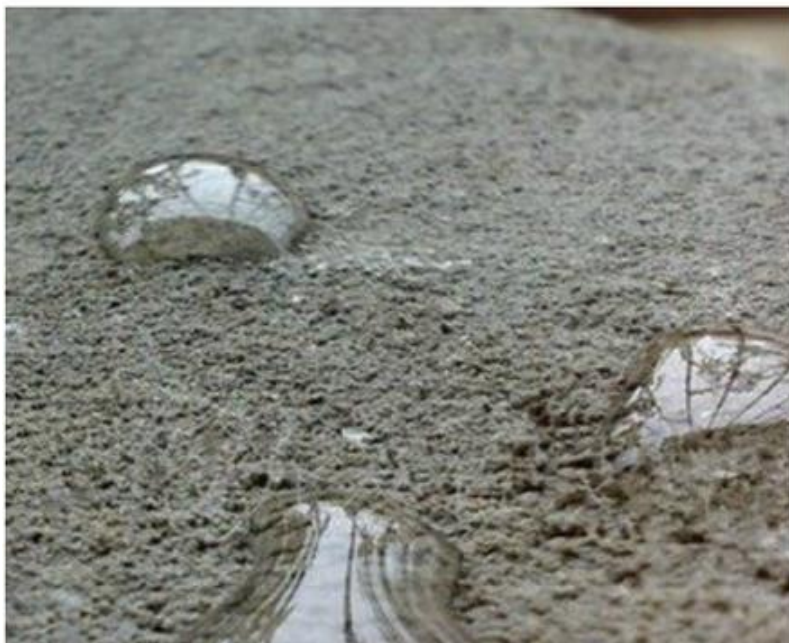
Рис. 4. Вода не проникает внутрь бетона и остается на поверхности благодаря добавке
