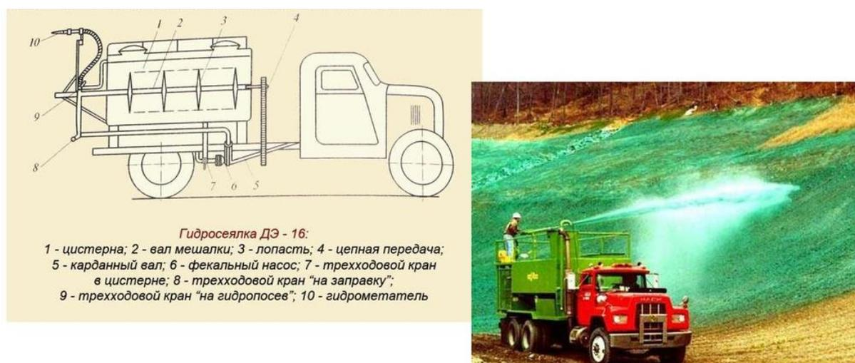
Рис. 1. Способ гидропосева
