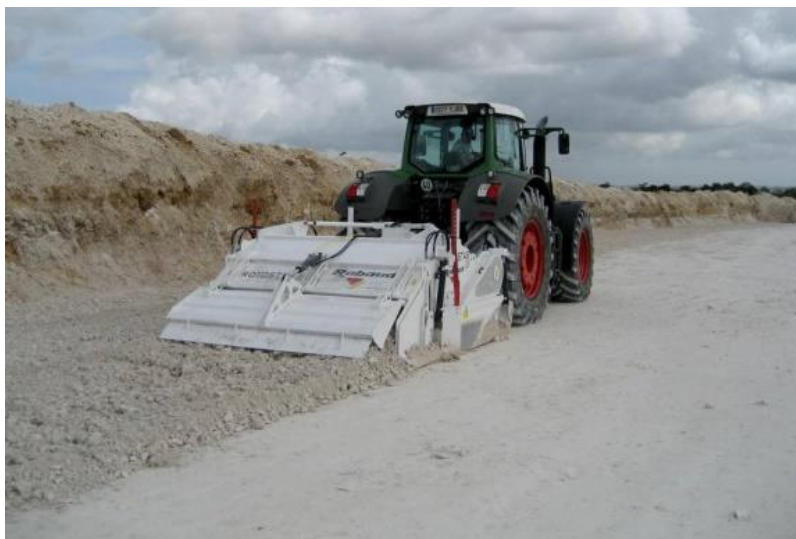
Рис. 1. Прицепной грунтовый смеситель для укрепления грунтов
