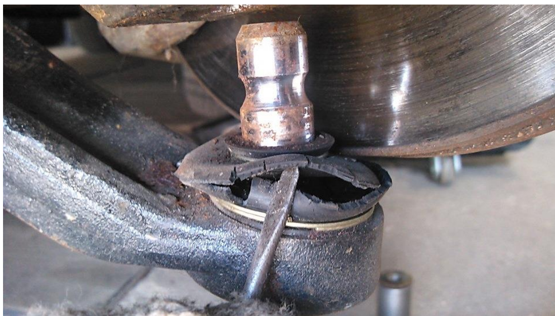
Рис. 1. Порванный пыльник шаровой опоры
