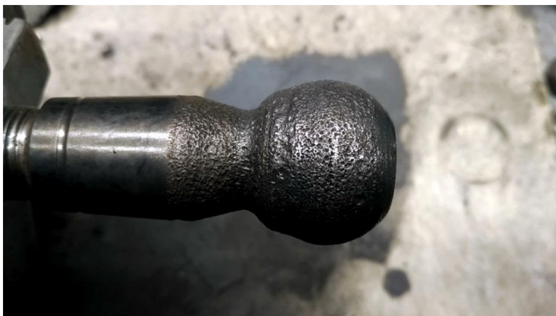
Рис. 2. Износ сферической поверхности пальца вследствие коррозионно-механического изнашивания
