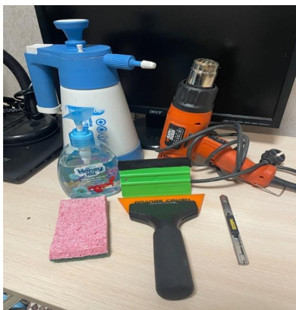
Рис. 1. Основные инструменты для тонирования стекол автомобиля
