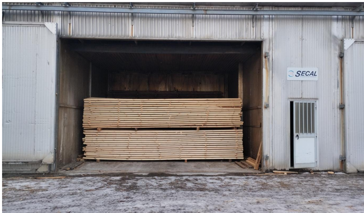
Рисунок 2 – Сушильная камера MGR-50
