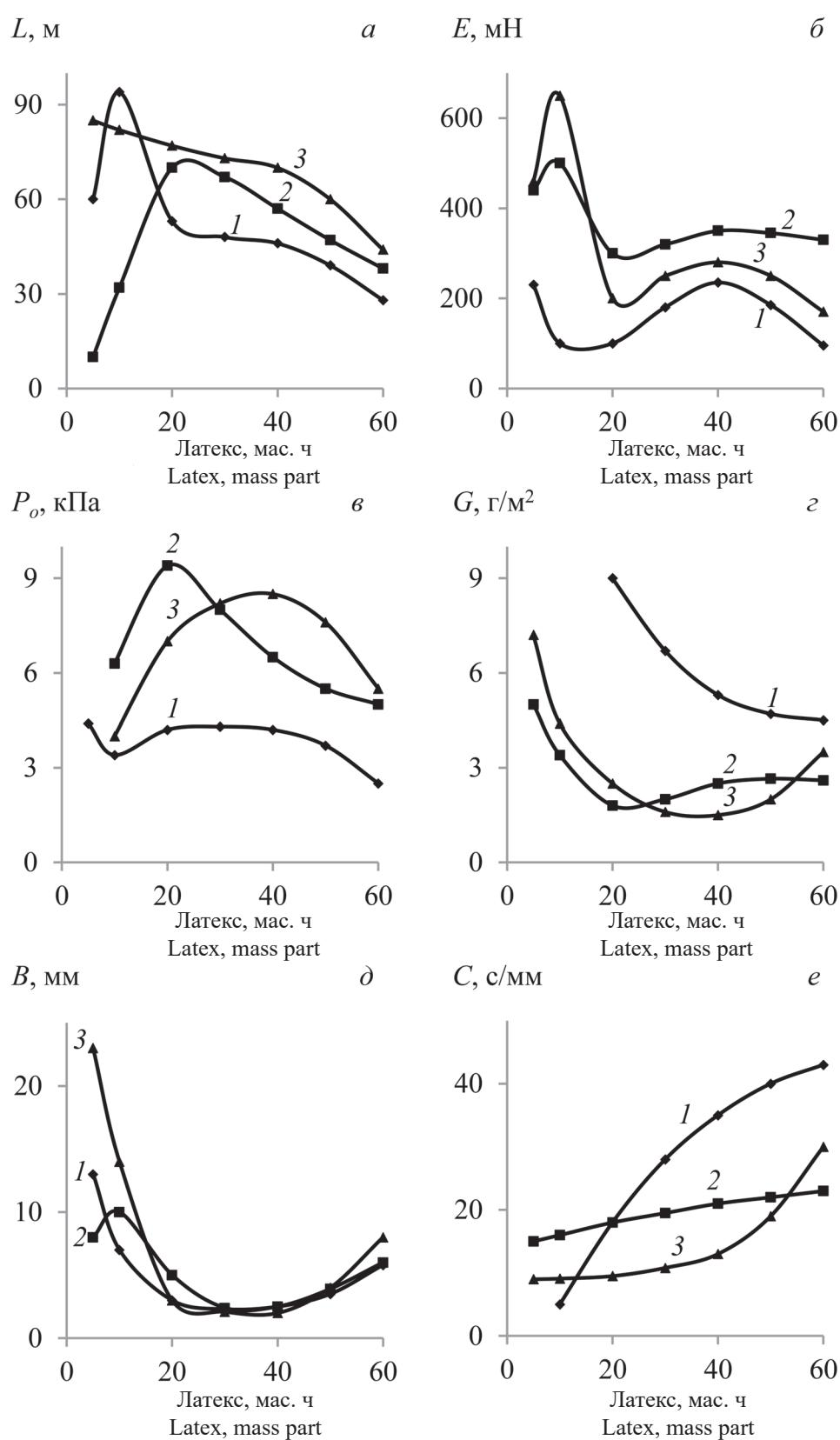
Рис. 3. Зависимость физико-механических показателей картона от содержания латекса БС-50 и сульфата алюминия, мас. ч.: 3,0 (1); 6,0 (2); 10,0 (3)
