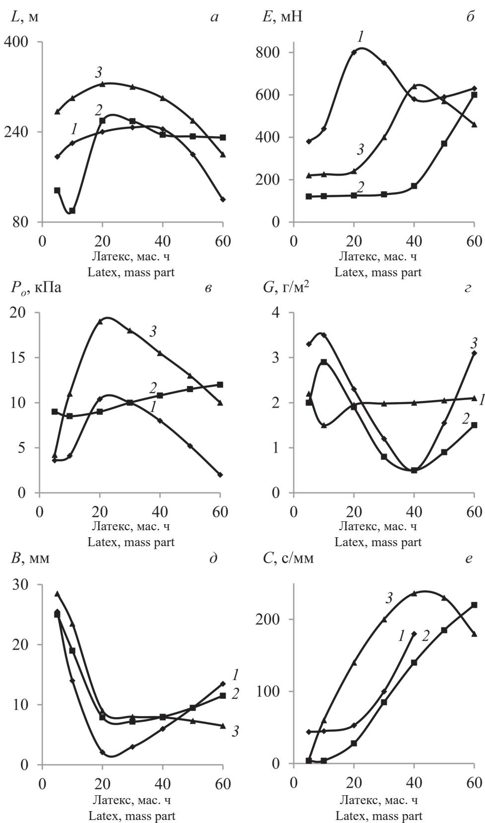
Рис. 2. Зависимость физико-механических показателей картона от содержания латекса СКС-65ГП и сульфата алюминия, мас. ч.: 3,0 (1); 6,0 (2); 10,0 (3)
