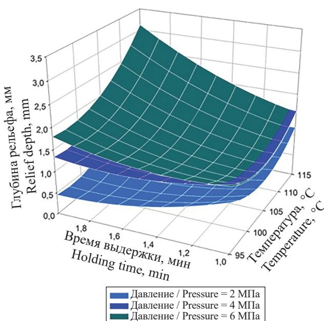
Рис. 3. Влияние параметров режима на глубину рельефа
