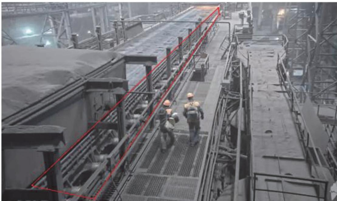
Рис. 9. Пример контроля опасных зон (Контроль зон..., 2023; Контроль опасных зон..., 2023)
