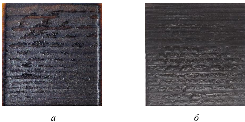
Рис. 1. Внешний вид поверхности древесины после обработки: a – кондуктивным обугливанием; б – обжигом
