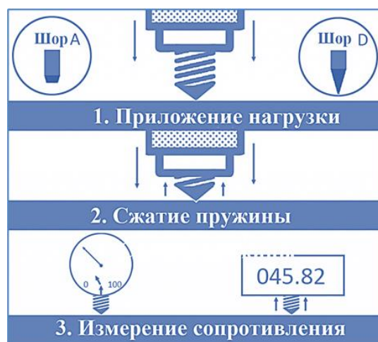
Рис. 2. Схема определения твердости по методу Шора
