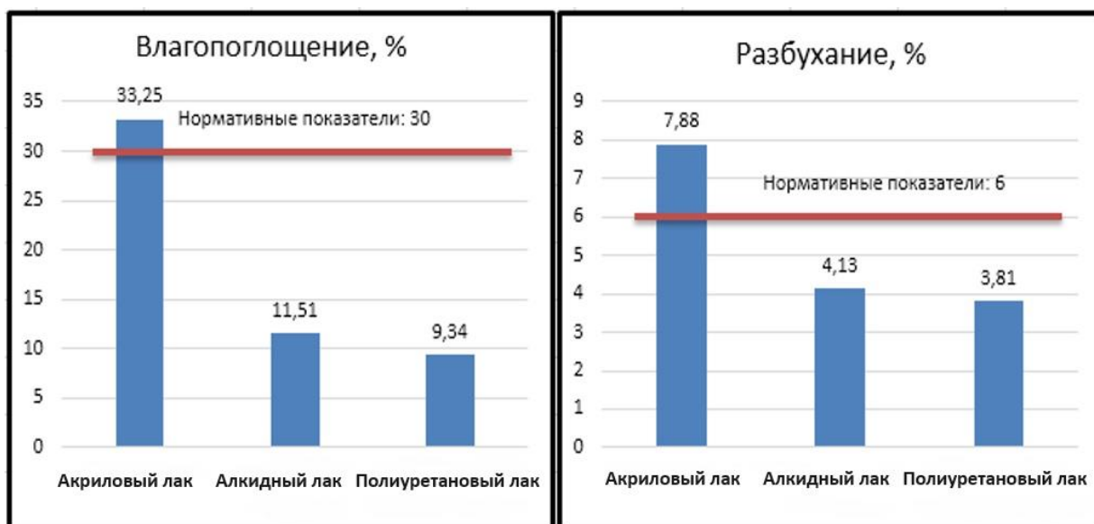
Рис. 2. Результат исследований влияния различных лакокрасочных материалов на величину влагопоглощения и разбухания
