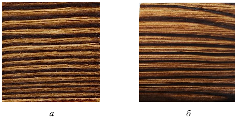
Рис. 2. Внешний вид поверхности древесины после обработки: a – обжигом и брашированием; б – кондуктивным обугливанием и брашированием
