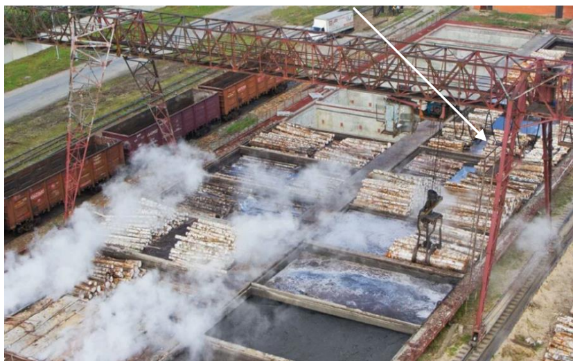
Рис. 4.4. Бассейн с консольно-козловым краном для прогрева фанерного сырья
