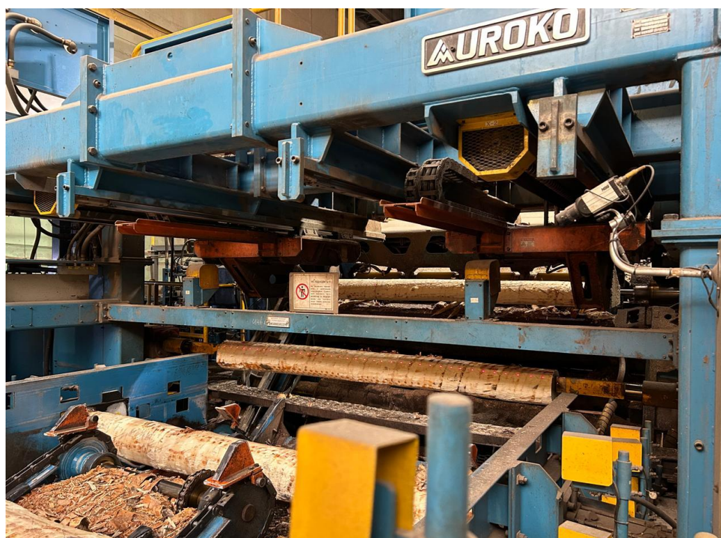
Рис. 4.11. Центрирующее загрузочное устройство Uroko перед лущильным станком
