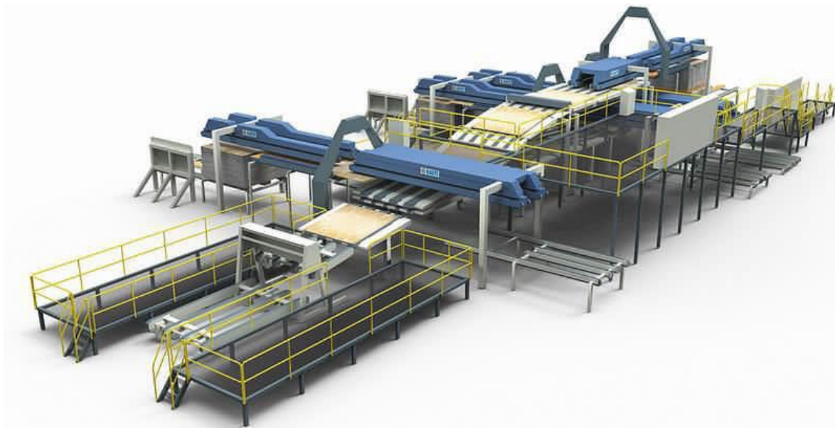
Рис. 4.25. Участок автоматизированной сборки пакетов фанеры (производитель фирма Raute)
