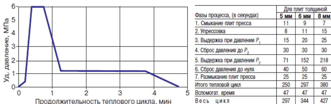
Рис. 3.8. Диаграмма горячего прессования ДВП сухим способом в 22-этажном прессе
