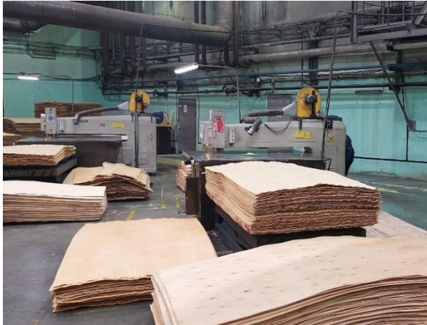
Рис. 4.16. Шпонопочинка на станке ПШ-2А
