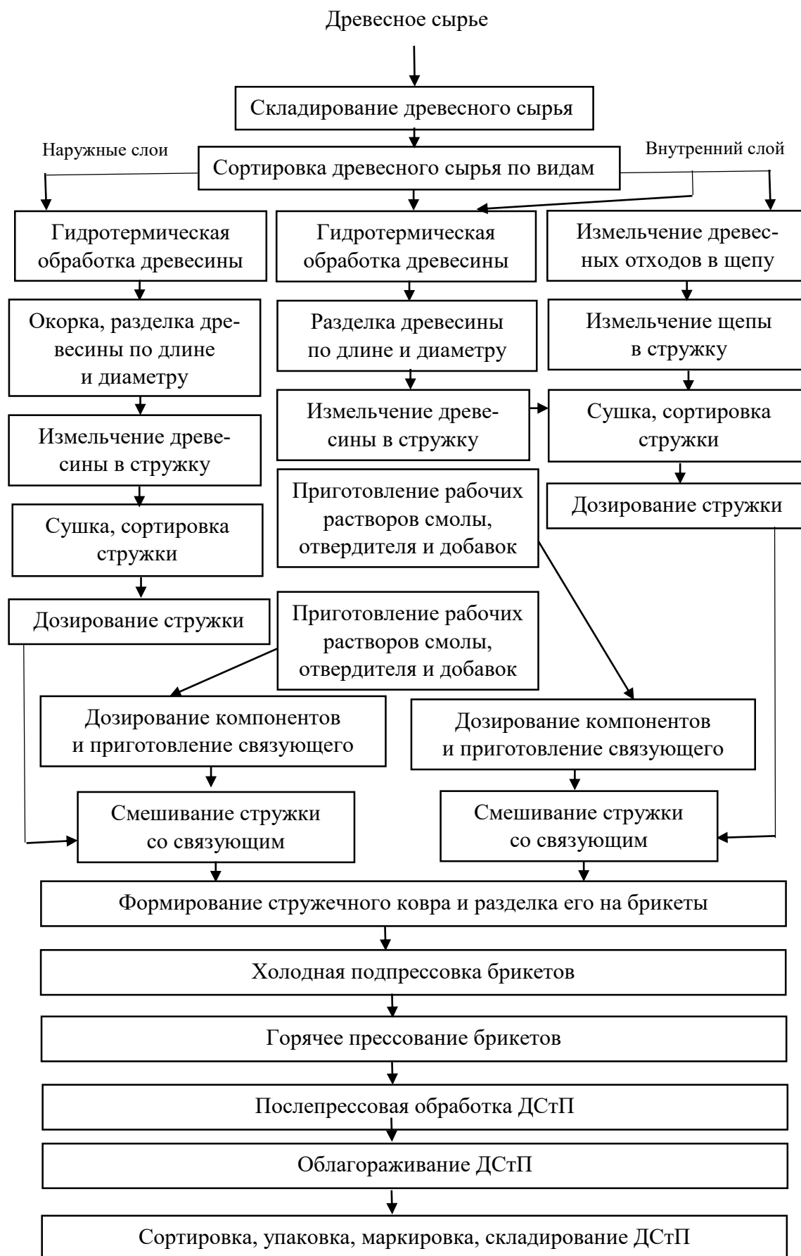
Рис. 2.7. Структурная схема получения трехслойных ДСтП [19]
