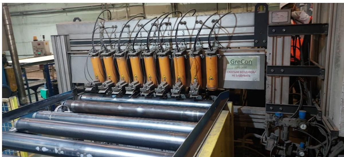
Рис. 4.30. Ультразвуковой сканер GreCon обнаружения дефектов фанеры после склеивания
