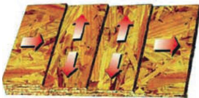
Рис. 2.11. Ориентация древесной стружки в ОСП [3]
