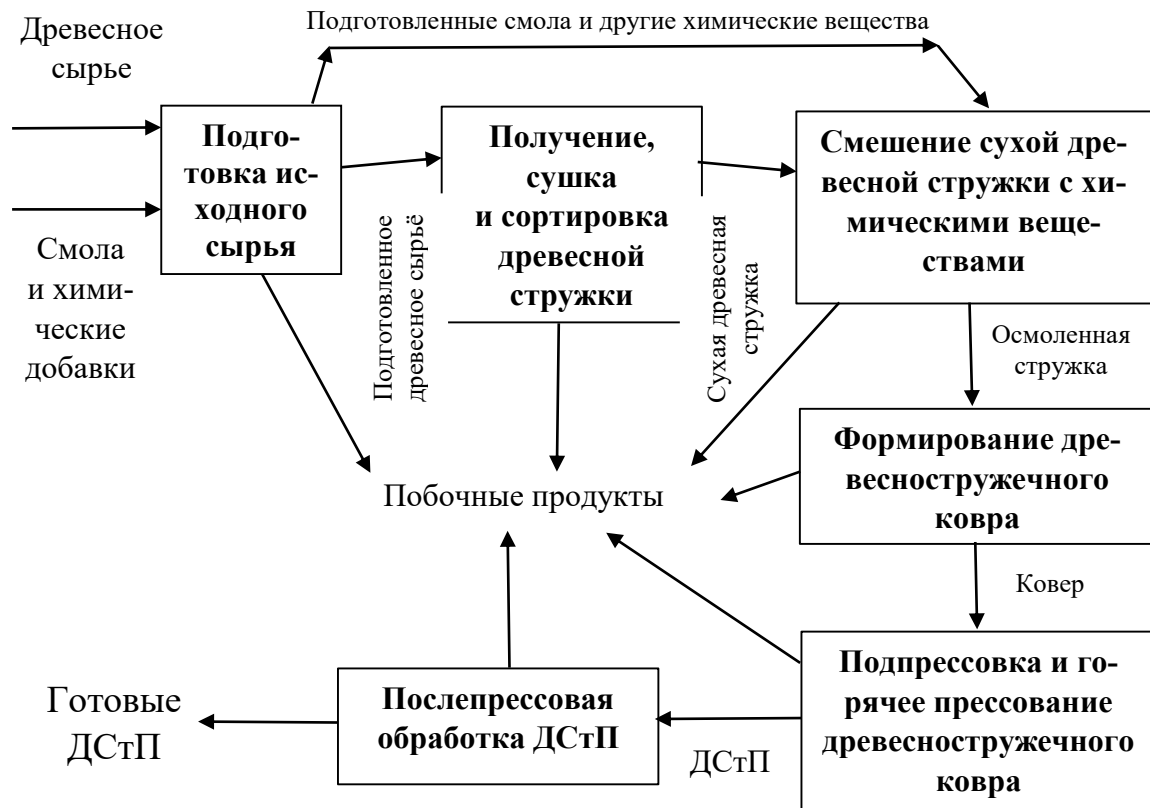
Рис. 2.6. Упрощенная структурная схема получения горячим прессованием однослойных ДСтП
