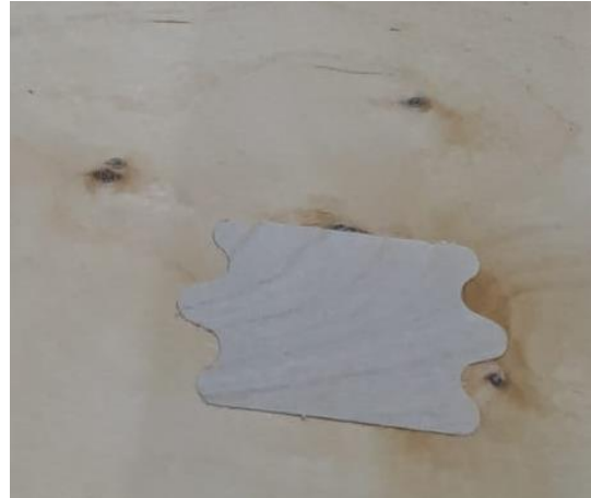
Рис. 4.17. Заплата, устанавливаемая на месте сучка в лист шпона
