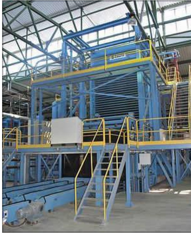
Рис. 4.28. Универсальный 30-этажный горячий пресс (Raute Select) для прессования большеформатной фанеры 4×8 и 5×10 футов
