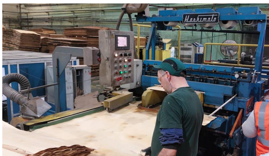
Рис. 4.18. Подача кускового шпона в полуавтоматическую линию ребросклеивания Hashimoto
