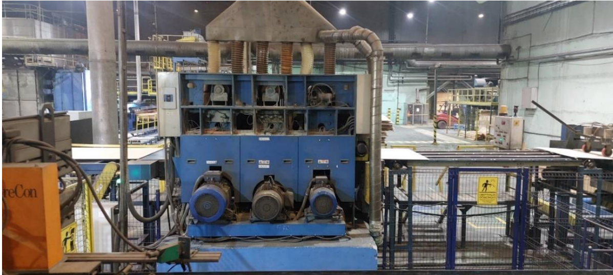
Рис. 4.31. Широколенточный шлифовальный станок Kikukawa (Япония)
